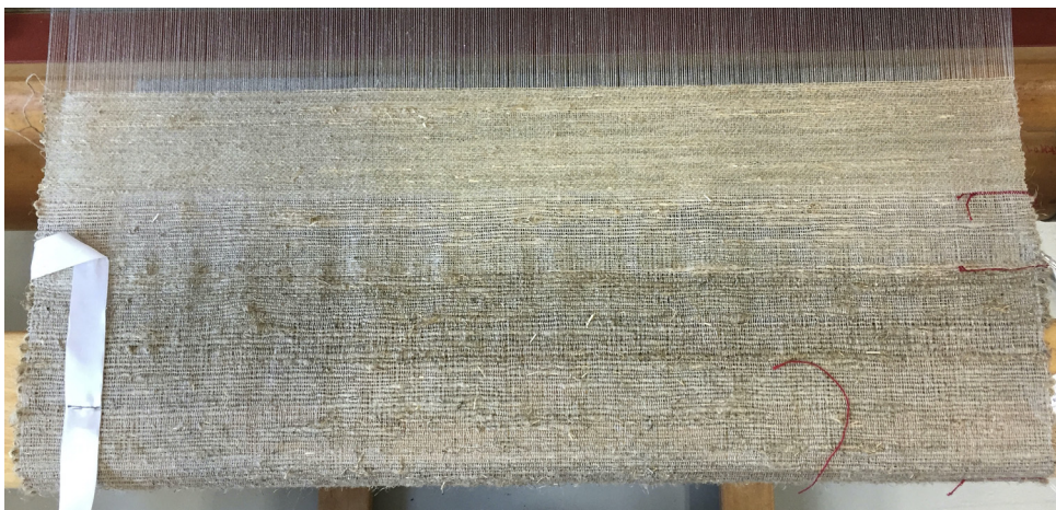
Abb. 2: Diverse Leinenqualitäten auf einem Handwebstuhl. Die Kette dieses Stückes ist Industrieware, während der Schuss aus verschiedenen handgesponnenen Qualitäten besteht
